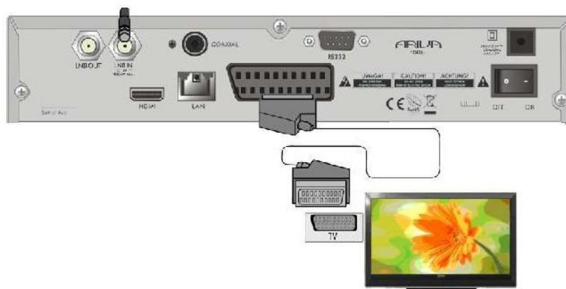
Rys. 1 Schemat połączenia tunera satelitarnego z OTVC:
